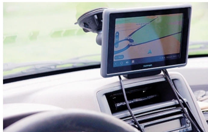
Il dispositivo montato sulle auto che rileva le asperità delle strade
